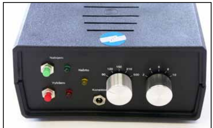
Nabíječka NiCd baterií s aut. řízením nabíjecího proudu s ochranou
