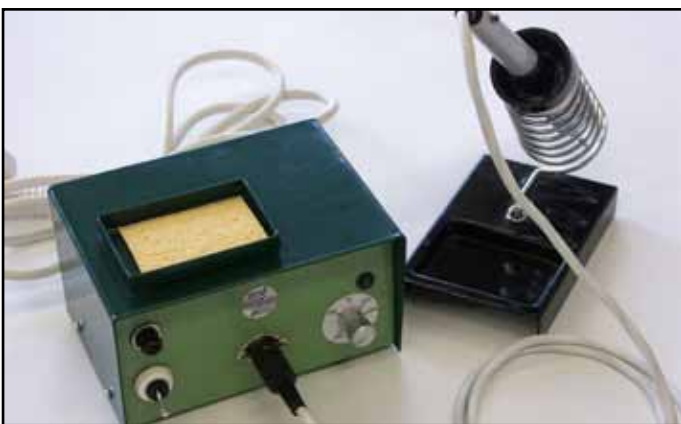
Mikropáječka s regulací teploty pájecího hrotu
