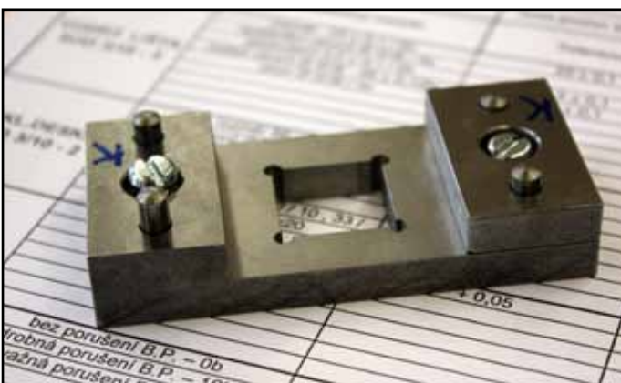
Licovací přípravek – souborná práce žáků oboru nástrojař ve 3. ročníku
