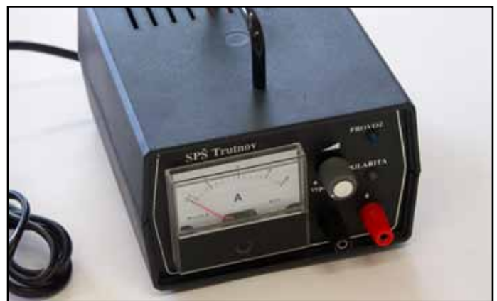
Nabíječka 12V automobilních akumulátorů s aut. řízením nabíjení
